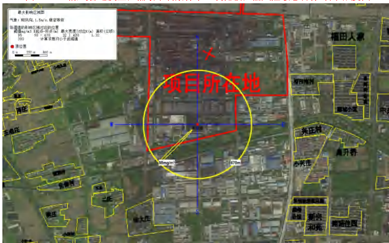
图 6.2.5-3 煤气管道发生泄漏最不利条件下一氧化碳泄漏风险敏感目标时间-浓度图
