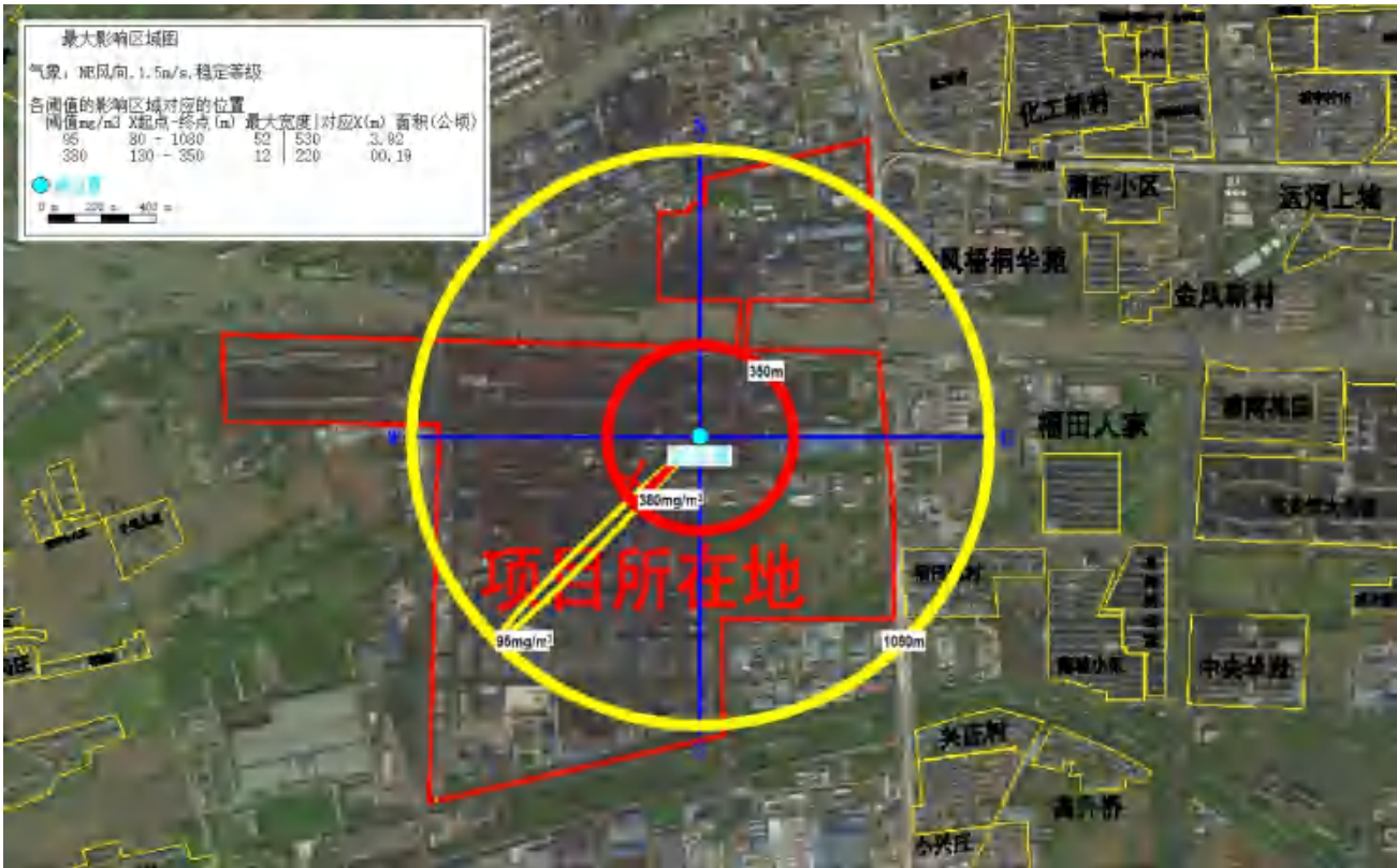
图 6.2.5-2 煤气柜发生泄漏一氧化碳泄漏最大影响区域图
