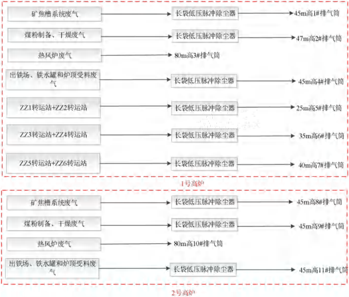
图 8.1-1 本项目废气收集系统流程框图
