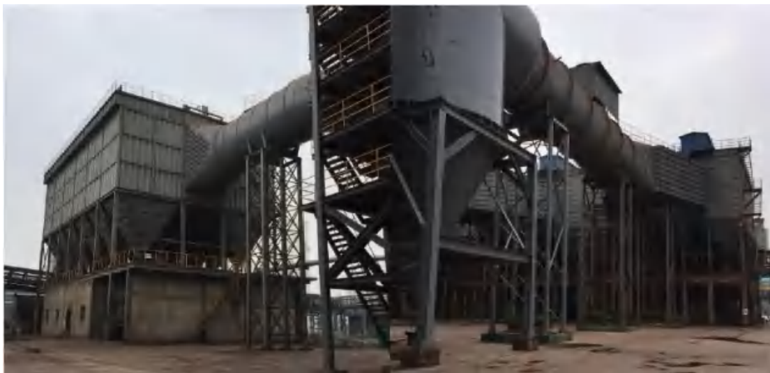
图 8.1-3 低压脉冲布袋除尘器
